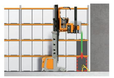
Limitazione dell'abbassamento in base alla posizione: per una maggiore sicurezza è possibile impedire alla cabina di abbassarsi a livello del pavimento in zone specifiche evitando danni al carrello, al carico o alle guide. Vantaggio: maggiore sicurezza in presenza di ostacoli a livello della pavimentazione.
