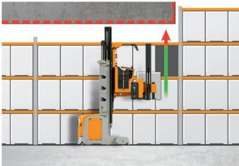
Limitazione locale dell'altezza: per aree specifiche di una corsia con scaffalatura è possibile limitare l'altezza massima di sollevamento. Questo permette di operare in corsie aventi altezze del soffitto variabili. Vantaggio: maggiore sicurezza in magazzini con altezze dei sotto travi non omogenee.
