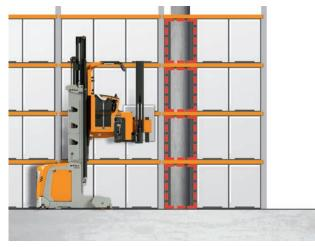
Blocco della corsa della attrezzatura in base alla posizione: è possibile bloccare la corsa della attrezzatura, evitando che le forche possano entrare in collisione con eventuali ostacoli esistenti. Vantaggio: una maggiore sicurezza grazie alla prevenzione di danni al carrello e alla merce.
