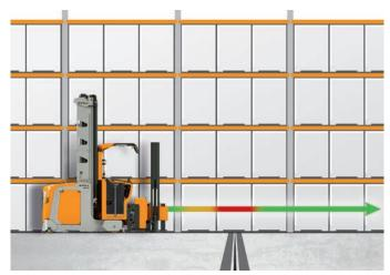
Limite di velocità in base alla posizione: in determinate aree è possibile limitare la velocità di marcia e di sollevamento del carrello per evitare danni al carrello o alla scaffalatura ove la pavimentazione sia irregolare, anche in assenza di un limite di velocità generale per tutte le corsie. Vantaggio: grazie a prestazioni migliori e a una maggiore sicurezza in aree con pavimentazione irregolare si ottiene un aumento della capacità di movimentazione.
