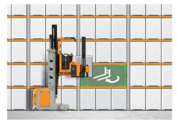
Blocco della rotazione delle forche in base alla posizione: è possibile impedire alle forche di ruotare su un lato della corsia in un'area specifica, per l'intera lunghezza della corsia o in aree definite. Questo diventa funzionale nel caso in cui sia possibile immagazzinare le merci unicamente su un lato della corsia o se la rotazione è consentita soltanto in determinati punti delle corsie strette. Vantaggio: una maggiore sicurezza grazie alla prevenzione di danni al carrello e alla merce.
