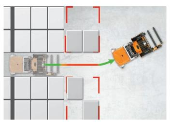
Blocco dello sterzo all'esterno della corsia: in uscita dalla corsia è possibile bloccare lo sterzo per una determinata distanza, in modo da evitare i pallet posizionati all'esterno della stessa, nella fase di allontanamento. Vantaggio: maggiore sicurezza grazie alla prevenzione di danni al carrello e alla merce.
