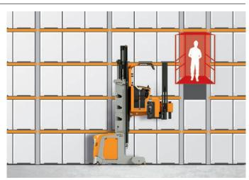
Protezione anticollisione: il carrello tiene conto di ostacoli fissi quali lampade, sistemi di sprinkler e collegamenti incrociati, prevenendo così le collisioni. Monitorando costantemente la distanza tra il carrello e gli oggetti circostanti, il carrello può fermarsi prima di colpire un ostacolo. Vantaggio: sfruttamento maggiore degli spazi del magazzino e accesso più semplice alle aree che in precedenza erano difficili da raggiungere a causa dei pericoli di collisione.
