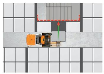
Riduzione della corsa della attrezzatura in base alla posizione: è possibile ridurre la corsa della attrezzatura di un certo valore in aree specifiche o lungo l'intero lato di una corsia per consentire di riporre in sicurezza pallet che presentano orientamenti e dimensioni diverse. Vantaggio: una maggiore sicurezza grazie alla prevenzione di danni al carrello o alla merce.
