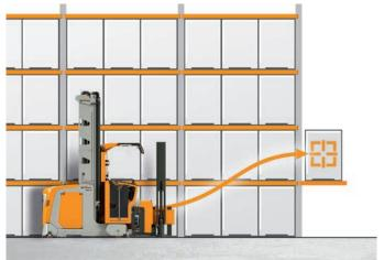
Assistente per le posizioni di pre-stoccaggio: tramite la tecnologia RFID è possibile definire delle posizioni pre-stock, posizionate davanti alle corsie, e richiamarle semplicemente con la pressione di un pulsante. Questa azione farà arrestare il carrello nella posizione selezionata. Vantaggio: una maggiore capacità di movimentazione grazie al minor tempo necessario per posizionarsi nel punto corrette.
