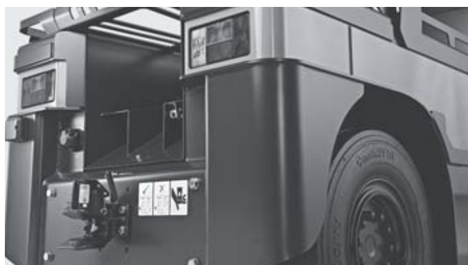
Trattore elettrico R 07: gancio di traino per l'uso come carrello elevatore da rimorchio
