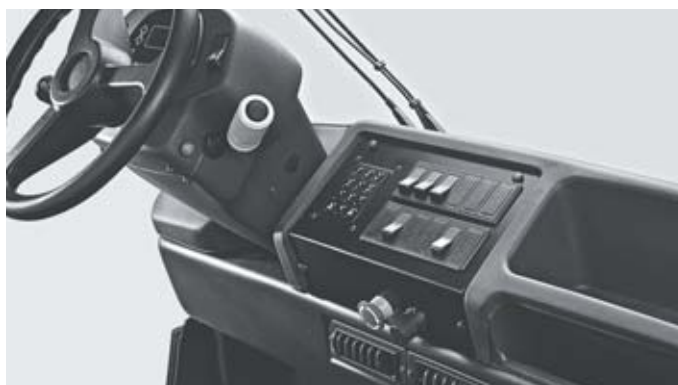
Freno di stazionamento elettrico e pannello strumenti funzionale con comparti per documenti e materiali di lavoro
