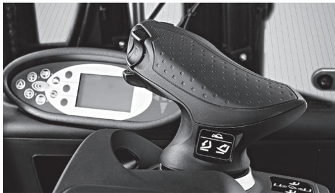
Operazioni ergonomiche, confortevoli e precise con il Joystick 4Plus
