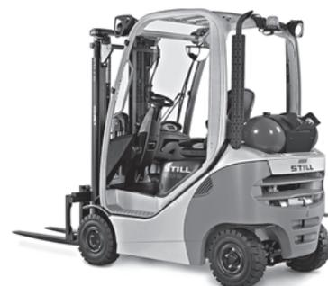
Il carrello elevatore a GPL RX 70-16/20 con una classe di portata fino a due tonnellate combina i vantaggi del potente motore a combustione con il controllo di precisione di una trasmissione elettrica, garantendo un'elevata disponibilità, una lunga durata e costi di esercizio inferiori. Il design compatto e la facile manovrabilità, abbinati alla sensibilità di trasmissione e comandi di sollevamento, garantiscono massime prestazioni di movimentazione.
