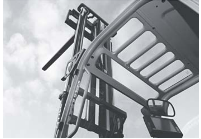
L'ampio vetro sul tettuccio della cabina di guida assicura una buona visibilità sopra il carico
