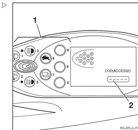
Se viene immesso un PIN operatore errato, viene visualizzato per un breve periodo di tempo il messaggio **INVALIDO**. Quando il messaggio scompare, il PIN operatore può essere immesso nuovamente.
