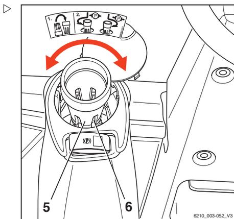
Dopo l'azionamento manuale, ricollocare il volantino nella propria posizione di fissaggio e il coperchio nella sua posizione normale.
