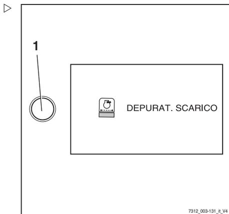
DEPURATORE GAS DI SCARICO ATTENDERE PREGO viene visualizzato sul display. La barra di stato (4) sotto il messaggio indica l'avanzamento del processo di rigenerazione.
