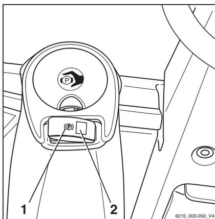
Se il freno di stazionamento elettrico è applicato, sul display viene visualizzato per 5 secondi il messaggio FRENO DI STAZIONAMENTO ATTIVO.
