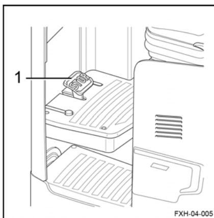
**Frenatura con l'opzione a pedale singolo** ▷**Frenatura tramite il pedale del freno**
