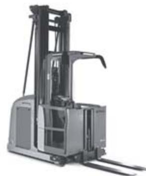
Il carrello EK-X per le sue caratteristiche rappresenta la massima espressione in termini di prestazioni, altezza di Picking, portata residua, funzionalità ed ergonomia. Diventa pertanto il nuovo punto di riferimento per il commissionamento in ogni tipo di magazzino VNA. Con la sua velocità di guida fino a 13 km/h e di sollevamento fino a 0,4 m/s, le operazioni di commissionamento diventano facili e veloci. Il sistema OPTISPEED, ottimizza i parametri in ogni fase operativa,
