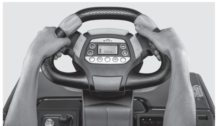
Grazie al volante STILL Easy Drive regolabile in altezza, sia gli operatori destrorsi che mancini possono azionare tutte le funzioni del carrello tramite elementi di comando ergonomici, senza necessità di cambiare mano<sup>3</sup>
