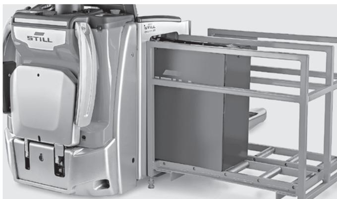
Sostituzione laterale della batteria grazie all'innovativo sistema di sblocco che rende questa operazione ancora più semplice e veloce<sup>2</sup>
