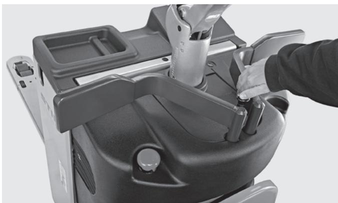
Sicurezza a 360°: le protezioni laterali opzionali possono essere chiuse facilmente e con rapidità, preservando la stabilità e la sicurezza dell'operatore e fornendo la protezione ottimale in tutte le situazioni di guida<sup>1</sup>
