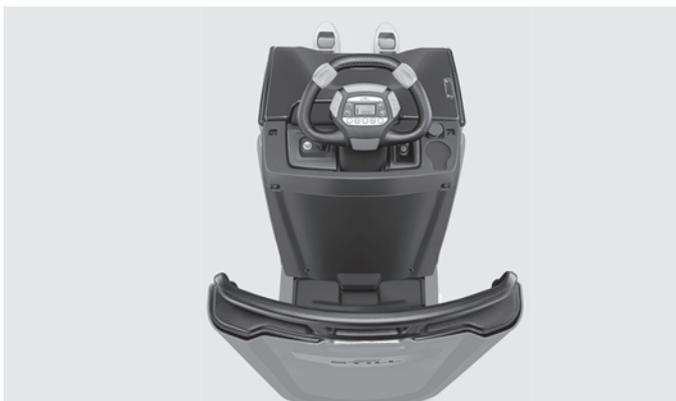
Schienale per il picking frequente e, opzionalmente, una pedana ammortizzata ad aria regolabile in modo individuale per tutti i modelli<sup>3</sup>
