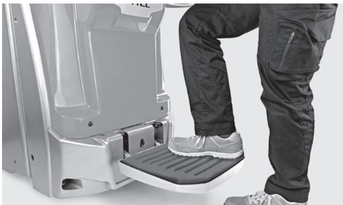
Protezioni laterali regolabili e la pedana, con molle ad aria, è regolabile in base al peso dell'operatore<sup>2</sup>
